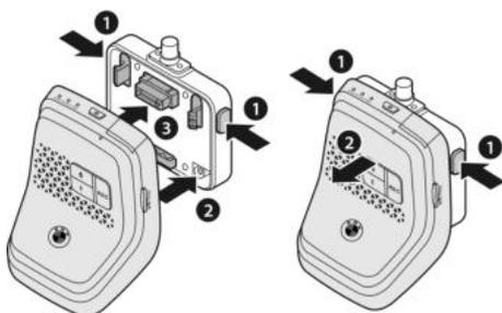
La telecamera anteriore può essere montata o rimossa premendo contemporaneamente i pulsanti (1) sui due lati del supporto telecamera.
